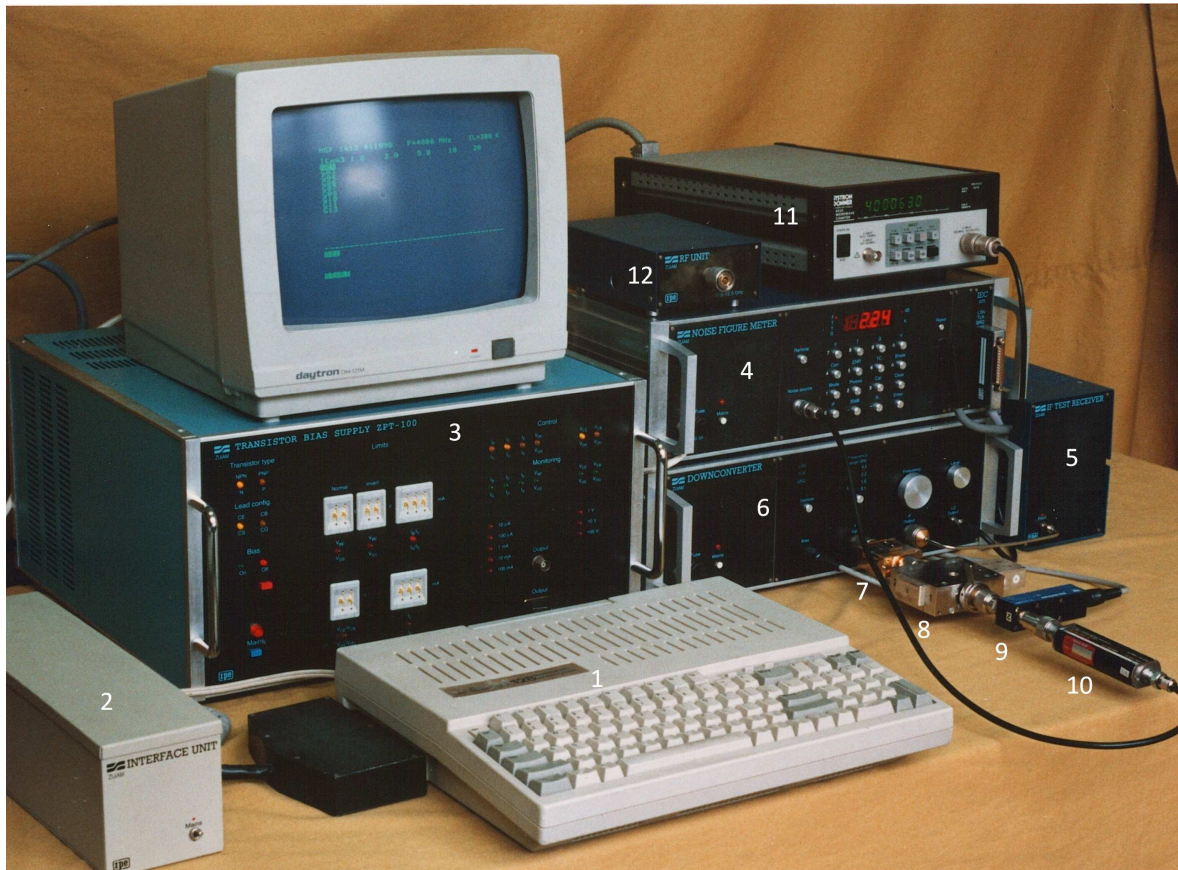
Rys. 2. System pomiarowy szumów (wersja z 1994 r.), zbudowany w ISE PW dla charakteryzowania przyrządów półprzewodnikowych. System zawiera zestaw komputerowy Laser 128 (1) z monitorem, sterujący za pośrednictwem interfejsu IEC-625 (2) zasilaczem tranzystorowym ZPT-100 (3) oraz cyfrowym miernikiem współczynnika szumów (4) wraz z odbiornikiem pomiarowym p.cz. (5). Na wejściu radiometru znajduje się konwerter pomiarowy (6) o zakresie częstotliwości od 0,1 do 4,3 GHz, do którego jest dołączona uniwersalna głowica mikrofalowa (7) z badanym tranzystorem wewnątrz, mechaniczny strojnik impedancji (8), układ polaryzacji (9) i cechowane źródło szumów (10). System jest wyposażony także w cyfrowy miernik (11) dla śledzenia częstotliwości heterodyny konwertera i dodatkowy układ przemiany częstotliwości (12) na zakres 11,5 – 12,5 GHz.
